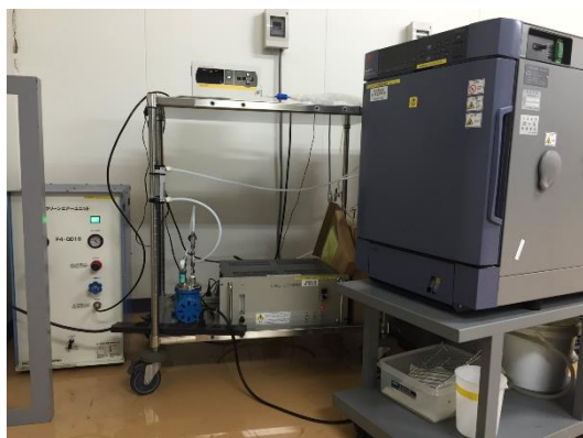
写真 7 : オゾン試験機
